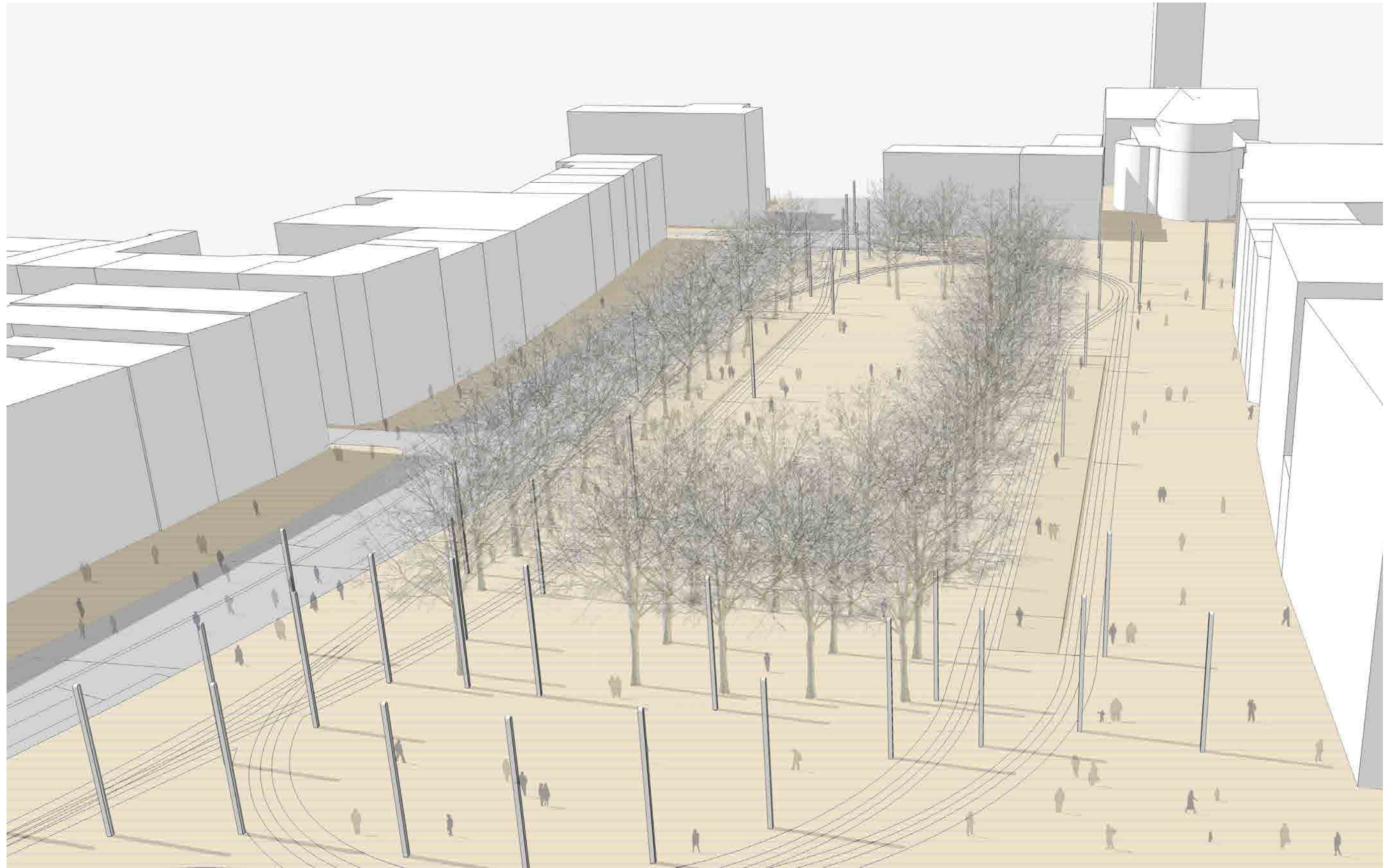
Untersuchung Haltestelle Neumarkt: Variante Umfahrung - Position Fahrleitungsmasten
